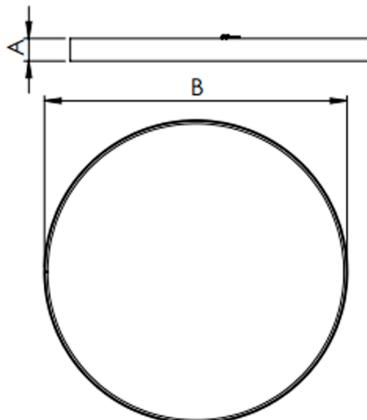
Luminária circular de sobrepor, 100W 3000K IRC>80. Corpo em alumínio. Acabamento Branca, Preta ou Especial. Controle óptico principal através de difusor em acrílico translúcido. Luminária grau de proteção IP-20. Driver corrente constante Liga/Desliga, Triac, 1-10V ou Dali (consultar condições). Tensão de trabalho 220V ou Bivolt.
