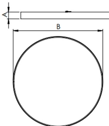
Luminária circular de sobrepor, 40W 2700K IRC>80. Corpo em alumínio. Acabamento Branca, Preta ou Especial. Controle óptico principal através de difusor em acrílico translúcido. Luminária grau de proteção IP-20. Driver corrente constante Liga/Desliga, Triac, 1-10V ou Dali (consultar condições). Tensão de trabalho 220V ou Bivolt.
