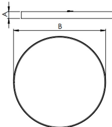
Luminária circular de sobrepor, 40W 5000K IRC>80. Corpo em alumínio. Acabamento Branca, Preta ou Especial. Controle óptico principal através de difusor em acrílico translúcido. Luminária grau de proteção IP-20. Driver corrente constante Liga/Desliga, Triac, 1-10V ou Dali (consultar condições). Tensão de trabalho 220V ou Bivolt.
