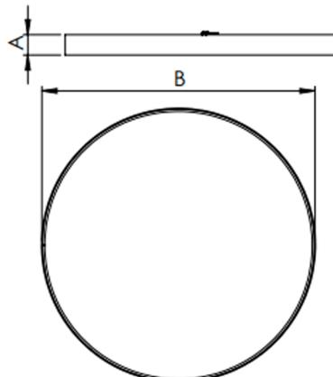
Luminária circular de sobrepor, 80W 2700K IRC>80. Corpo em alumínio. Acabamento Branca, Preta ou Especial. Controle óptico principal através de difusor em acrílico translúcido. Luminária grau de proteção IP-20. Driver corrente constante Liga/Desliga, Triac, 1-10V ou Dali (consultar condições). Tensão de trabalho 220V ou Bivolt.
