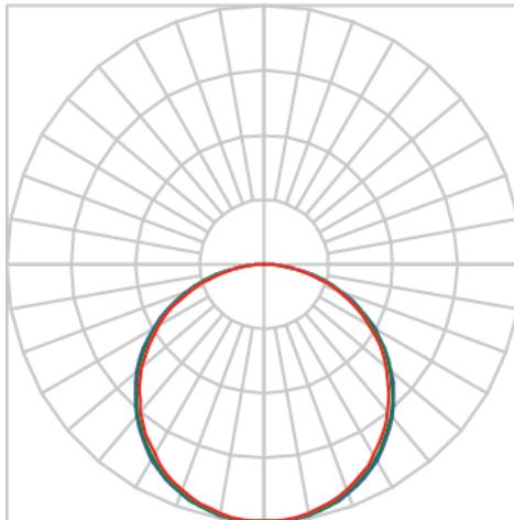
Luminária circular de sobrepor, 80W 4000K IRC>80. Corpo em alumínio. Acabamento Branca, Preta ou Especial. Controle óptico principal através de difusor em acrílico translúcido. Luminária grau de proteção IP-20. Driver corrente constante Liga/Desliga, Triac, 1-10V ou Dali (consultar condições). Tensão de trabalho 220V ou Bivolt.
