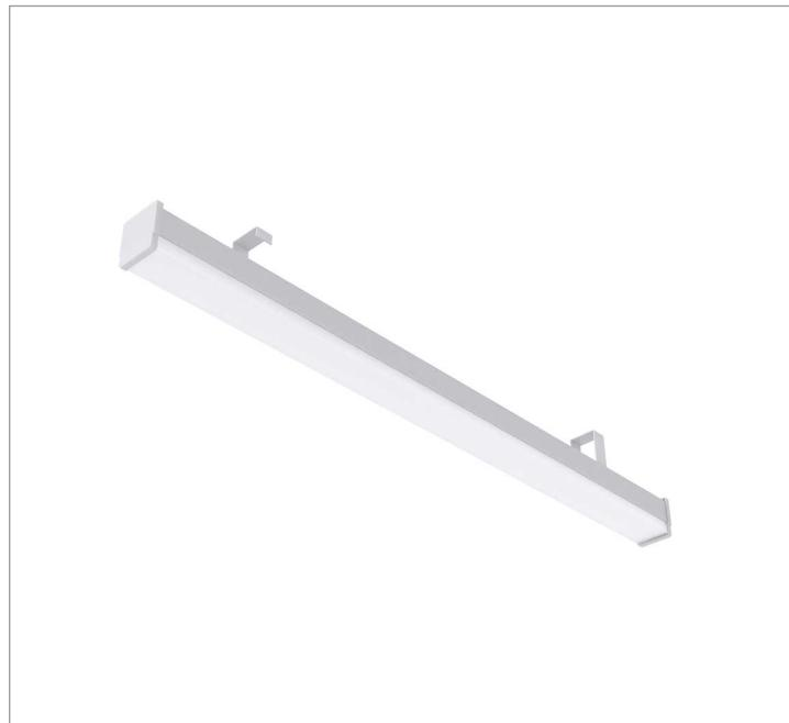
Luminária retangular para perfilado, 20W 2700K IRC>80. Corpo em alumínio. Acabamento Branca, Preta ou Especial. Controle óptico principal através de difusor em acrílico translúcido. Luminária grau de proteção IP-40. Driver corrente constante Liga/Desliga, Triac, 1-10V ou Dali (consultar condições). Tensão de trabalho 220V ou Bivolt.
