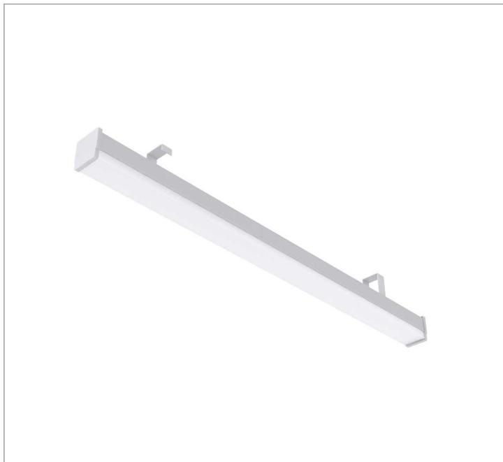
Luminária retangular para perfilado, 54W 2700K IRC>80. Corpo em alumínio. Acabamento Branca, Preta ou Especial. Controle óptico principal através de difusor em acrílico translúcido. Luminária grau de proteção IP-40. Driver corrente constante Liga/Desliga, Triac, 1-10V ou Dali (consultar condições). Tensão de trabalho 220V ou Bivolt.
