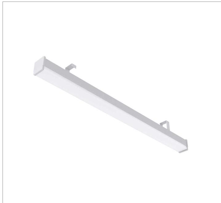
Luminária retangular para perfilado, 54W 4000K IRC>80. Corpo em alumínio. Acabamento Branca, Preta ou Especial. Controle óptico principal através de difusor em acrílico translúcido. Luminária grau de proteção IP-40. Driver corrente constante Liga/Desliga, Triac, 1-10V ou Dali (consultar condições). Tensão de trabalho 220V ou Bivolt.
