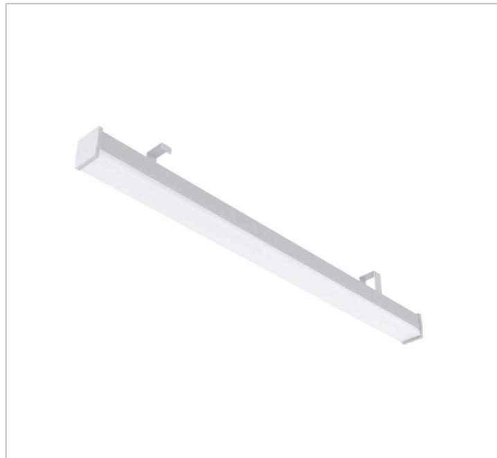
Luminária retangular para perfilado, 75W 5000K IRC>80. Corpo em alumínio. Acabamento Branca, Preta ou Especial. Controle óptico principal através de difusor em acrílico translúcido. Luminária grau de proteção IP-40. Driver corrente constante Liga/Desliga, Triac, 1-10V ou Dali (consultar condições). Tensão de trabalho 220V ou Bivolt.
