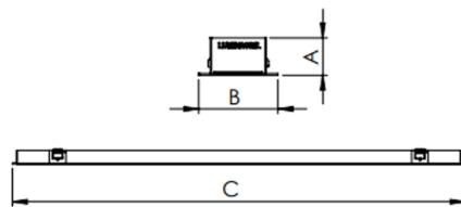
Luminária linear de embutir em forro de gesso, 15Wm 4000K IRC>80. Corpo em alumínio. Acabamento Branca, Preta ou Especial. Controle óptico principal através de difusor extrudado. Luminária grau de proteção IP-20. Driver corrente constante Liga/Desliga, Triac, 1-10V ou Dali (consultar condições). Tensão de trabalho 220V ou Bivolt.
