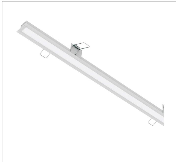
Luminária linear de embutir em forro de gesso, 25Wm 4000K IRC>80. Corpo em alumínio. Acabamento Branca, Preta ou Especial. Controle óptico principal através de difusor em poliestireno translúcido. Luminária grau de proteção IP-20. Driver corrente constante Liga/Desliga, Triac, 1-10V ou Dali (consultar condições). Tensão de trabalho 220V ou Bivolt.
