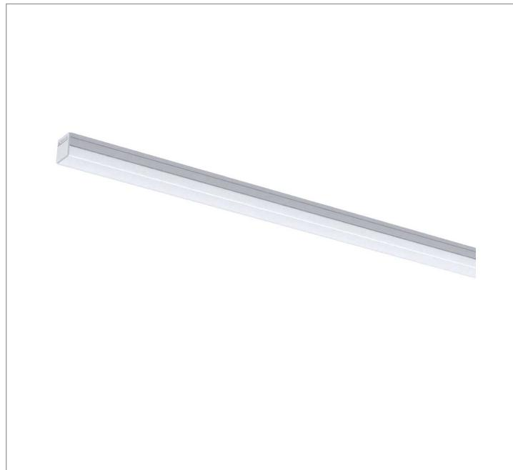
Luminária linear de sobrepor, 15Wm 4000K IRC>80. Corpo em alumínio. Acabamento Branca, Preta ou Especial. Controle óptico principal através de difusor extrudado. Luminária grau de proteção IP-20. Driver corrente constante Liga/Desliga, Triac, 1-10V ou Dali (consultar condições). Tensão de trabalho 220V ou Bivolt.
