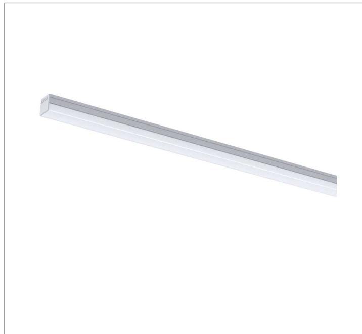
Luminária linear de sobrepor, 15Wm 3000K IRC>80. Corpo em alumínio. Acabamento Branca, Preta ou Especial. Controle óptico principal através de facho difuso. Luminária grau de proteção IP-20. Driver corrente constante Liga/Desliga, Triac, 1-10V ou Dali (consultar condições). Tensão de trabalho 220V ou Bivolt.
