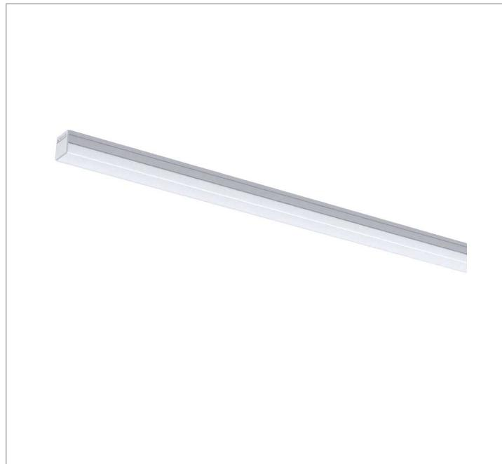
Luminária linear de sobrepor, 15Wm 4000K IRC>80. Corpo em alumínio. Acabamento Branca, Preta ou Especial. Controle óptico principal através de facho difuso. Luminária grau de proteção IP-20. Driver corrente constante Liga/Desliga, Triac, 1-10V ou Dali (consultar condições). Tensão de trabalho 220V ou Bivolt.
