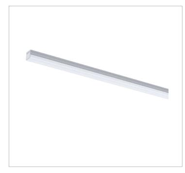
Luminária linear de sobrepor, 25Wm 5000K IRC>80. Corpo em alumínio. Acabamento Branca, Preta ou Especial. Controle óptico principal através de facho difuso. Luminária grau de proteção IP-20. Driver corrente constante Liga/Desliga, Triac, 1-10V ou Dali (consultar condições). Tensão de trabalho 220V ou Bivolt.
