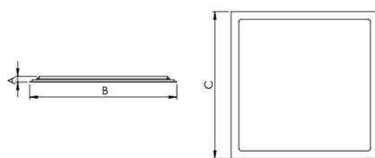
Luminária quadrada de embutir em forro de gesso, 40W 3000K IRC>80. Corpo em alumínio. Acabamento Branca. Controle óptico principal através de facho difuso. Luminária grau de proteção IP-20. Driver corrente constante Liga/Desliga Tensão de trabalho Bivolt.
