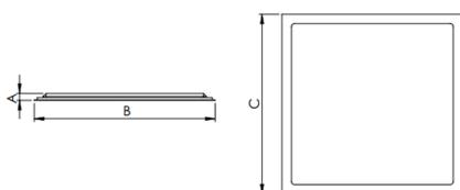
Luminária quadrada de embutir em forro modulado, 40W 4000K IRC>80. Corpo em alumínio. Acabamento Branca. Controle óptico principal através de facho difuso. Luminária grau de proteção IP-20. Driver corrente constante Liga/Desliga Tensão de trabalho Bivolt.
