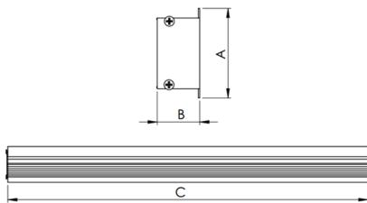
Luminária linear, 15W/m 4000K IRC>80. Corpo em alumínio. Acabamento Branca, Preta ou Especial. Controle óptico principal através de difusor extrudado. Luminária grau de proteção IP-20. Driver corrente constante Liga/Desliga, Triac, 1-10V ou Dali (consultar condições). Tensão de trabalho 220V ou Bivolt.
