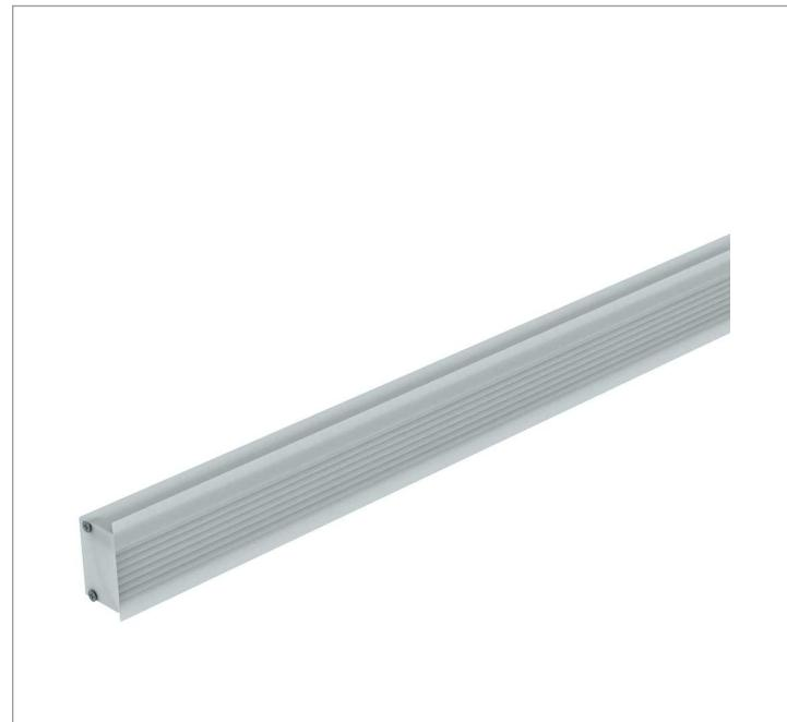
Luminária linear, 25Wm 2700K IRC>80. Corpo em alumínio. Acabamento Branca, Preta ou Especial. Controle óptico principal através de difusor extrudado. Luminária grau de proteção IP-20. Driver corrente constante Liga/Desliga, Triac, 1-10V ou Dali (consultar condições). Tensão de trabalho 220V ou Bivolt.
