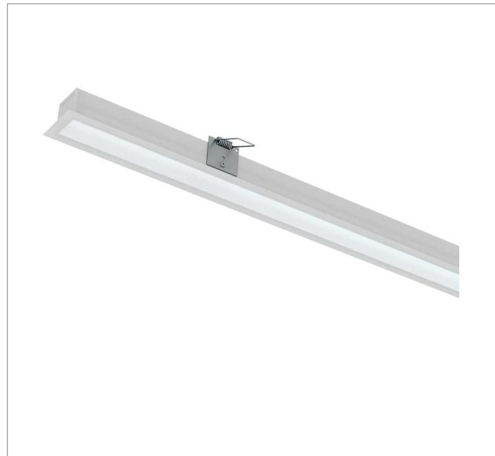
Luminária linear de embutir em forro de gesso, 25Wm 2700K IRC>80. Corpo em alumínio. Acabamento Branca, Preta ou Especial. Controle óptico principal através de difusor extrudado. Luminária grau de proteção IP-20. Driver corrente constante Liga/Desliga, Triac, 1-10V ou Dali (consultar condições). Tensão de trabalho 220V ou Bivolt.
