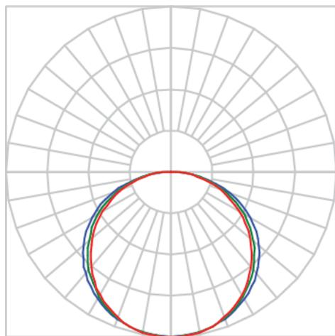
Luminária linear pendente iluminação direta, 15Wm 2700K IRC>80. Corpo em alumínio. Acabamento Branca, Preta ou Especial. Controle óptico principal através de difusor extrudado. Luminária grau de proteção IP-20. Driver corrente constante Liga/Desliga, Triac, 1-10V ou Dali (consultar condições). Tensão de trabalho 220V ou Bivolt.
