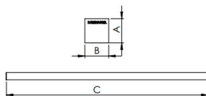
Luminária linear pendente iluminação direta, 25Wm 5000K IRC>80. Corpo em alumínio. Acabamento Branca, Preta ou Especial. Controle óptico principal através de difusor extrudado. Luminária grau de proteção IP-20. Driver corrente constante Liga/Desliga, Triac, 1-10V ou Dali (consultar condições). Tensão de trabalho 220V ou Bivolt.
