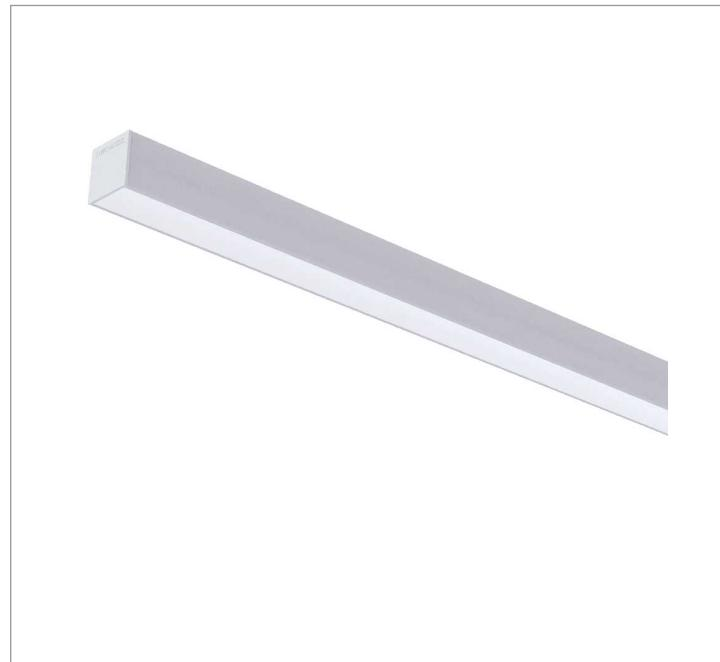
Luminária linear de sobrepor, 15Wm 5000K IRC>80. Corpo em alumínio. Acabamento Branca, Preta ou Especial. Controle óptico principal através de difusor extrudado. Luminária grau de proteção IP-20. Driver corrente constante Liga/Desliga, Triac, 1-10V ou Dali (consultar condições). Tensão de trabalho 220V ou Bivolt.
