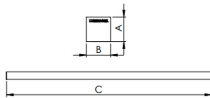
Luminária linear de sobrepor, 25Wm 4000K IRC>80. Corpo em alumínio. Acabamento Branca, Preta ou Especial. Controle óptico principal através de difusor extrudado. Luminária grau de proteção IP-20. Driver corrente constante Liga/Desliga, Triac, 1-10V ou Dali (consultar condições). Tensão de trabalho 220V ou Bivolt.
