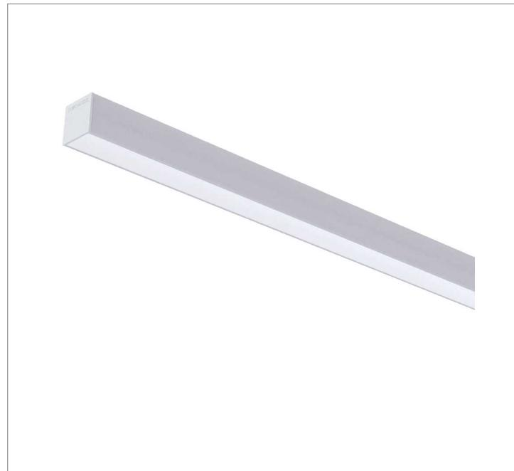
Luminária linear de sobrepor, 15Wm 5000K IRC>80. Corpo em alumínio. Acabamento Branca, Preta ou Especial. Controle óptico principal através de difusor em poliestireno translúcido. Luminária grau de proteção IP-20. Driver corrente constante Liga/Desliga, Triac, 1-10V ou Dali (consultar condições). Tensão de trabalho 220V ou Bivolt.
