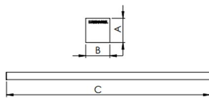
Luminária linear de sobrepor, 25Wm 4000K IRC>80. Corpo em alumínio. Acabamento Branca, Preta ou Especial. Controle óptico principal através de difusor em poliestireno translúcido. Luminária grau de proteção IP-20. Driver corrente constante Liga/Desliga, Triac, 1-10V ou Dali (consultar condições). Tensão de trabalho 220V ou Bivolt.
