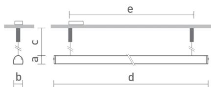
Luminária linear pendente iluminação direta, 15Wm 2700K IRC>80. Corpo em alumínio. Acabamento branco, preto ou especial. Controle óptico principal através de difusor em poliestireno prismático cristal linear. Luminária grau de proteção IP-20. Driver corrente constante Liga/Desliga, Triac, 1-10V ou Dali (consultar condições). Tensão de trabalho 220V ou Bivolt.
