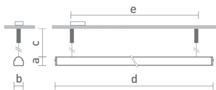
Luminária linear pendente iluminação direta, 25Wm 3000K IRC>80. Corpo em alumínio. Acabamento branco, preto ou especial. Controle óptico principal através de difusor em poliestireno prismático cristal linear. Luminária grau de proteção IP-20. Driver corrente constante Liga/Desliga, Triac, 1-10V ou Dali (consultar condições). Tensão de trabalho 220V ou Bivolt.
