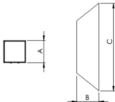
Luminária retangular arandela iluminação direta e indireta, 8W 2700K IRC>80. Corpo em alumínio. Acabamento Branca, Preta ou Especial. Controle óptico principal através de facho 60°. Luminária grau de proteção IP-20. Driver corrente constante Liga/Desliga Tensão de trabalho 127V ou 220V.
