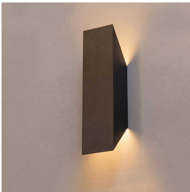
Luminária retangular arandela iluminação direta e indireta, 8W 3000K IRC>80. Corpo em alumínio. Acabamento Branca, Preta ou Especial. Controle óptico principal através de facho 60°. Luminária grau de proteção IP-20. Driver corrente constante Liga/Desliga Tensão de trabalho 127V ou 220V.
