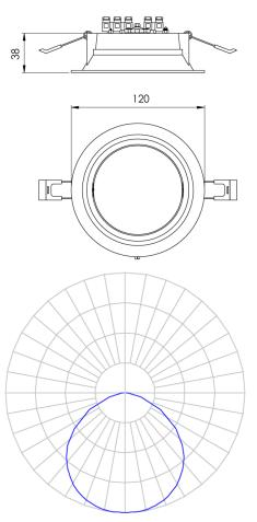
Luminária circular de embutir em forro de gesso, 10W 4000K IRC90. Corpo em alumínio injetado. Acabamento branco. Controle óptico principal através de difusor em poliestireno translúcido. Luminária grau de proteção IP-30. Driver corrente constante Liga/Desliga, Triac, 1-10V ou Dali (consultar condições). Tensão de trabalho 220V ou Bivolt.
