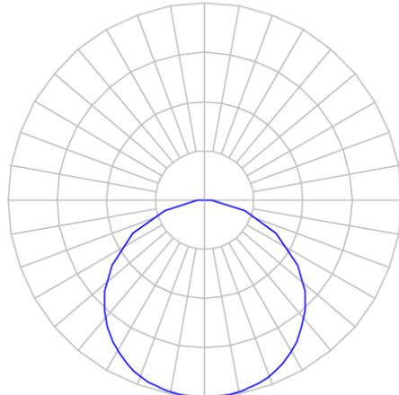
Luminária circular de embutir em forro de gesso, 14W 3000K IRC90. Corpo em alumínio injetado. Acabamento branco. Controle óptico principal através de difusor em poliestireno translúcido. Luminária grau de proteção IP-30. Driver corrente constante Liga/Desliga, Triac, 1-10V ou Dali (consultar condições). Tensão de trabalho 220V ou Bivolt.
