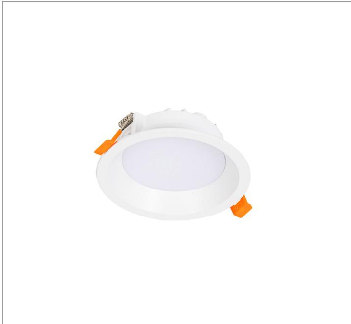
Luminária circular de embutir em forro de gesso, 14W 4000K IRC90. Corpo em alumínio injetado. Acabamento branco. Controle óptico principal através de difusor em poliestireno translúcido. Luminária grau de proteção IP-30. Driver corrente constante Liga/Desliga, Triac, 1-10V ou Dali (consultar condições). Tensão de trabalho 220V ou Bivolt.
