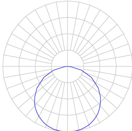
Luminária circular de embutir em forro de gesso, 27W 3000K IRC90. Corpo em alumínio injetado. Acabamento branco. Controle óptico principal através de difusor em poliestireno translúcido. Luminária grau de proteção IP-30. Driver corrente constante Liga/Desliga, Triac, 1-10V ou Dali (consultar condições). Tensão de trabalho 220V ou Bivolt.
