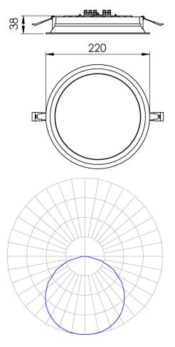
Luminária circular de embutir em forro de gesso, 31W 3000K IRC90. Corpo em alumínio injetado. Acabamento branco. Controle óptico principal através de difusor em poliestireno translúcido. Luminária grau de proteção IP-30. Driver corrente constante Liga/Desliga, Triac, 1-10V ou Dali (consultar condições). Tensão de trabalho 220V ou Bivolt.
