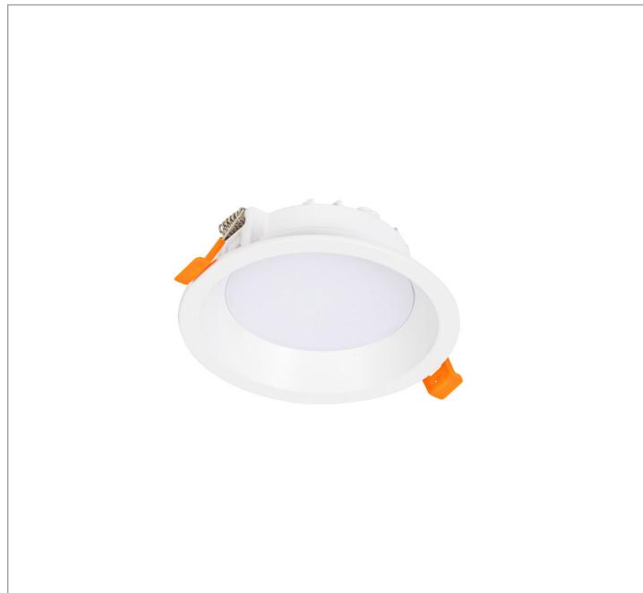
Luminária circular de embutir em forro de gesso, 6W 3000K IRC90. Corpo em alumínio injetado. Acabamento branco. Controle óptico principal através de difusor em poliestireno translúcido. Luminária grau de proteção IP-30. Driver corrente constante Liga/Desliga, Triac, 1-10V ou Dali (consultar condições). Tensão de trabalho 220V ou Bivolt.
