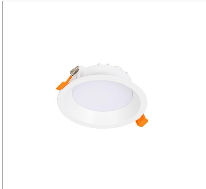
Luminária circular de embutir em forro de gesso, 6W 4000K IRC90. Corpo em alumínio injetado. Acabamento branco. Controle óptico principal através de difusor em poliestireno translúcido. Luminária grau de proteção IP-30. Driver corrente constante Liga/Desliga, Triac, 1-10V ou Dali (consultar condições). Tensão de trabalho 220V ou Bivolt.
