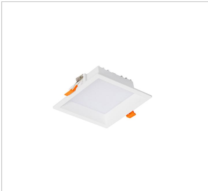
Luminária quadrada de embutir em forro de gesso, 10W 3000K IRC90. Corpo em alumínio injetado. Acabamento branco. Controle óptico principal através de difusor em poliestireno translúcido. Luminária grau de proteção IP-30. Driver corrente constante Liga/Desliga, Triac, 1-10V ou Dali (consultar condições). Tensão de trabalho 220V ou Bivolt.
