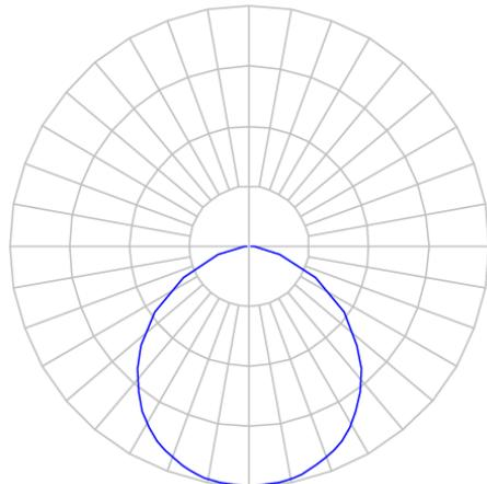
Luminária quadrada de embutir em forro de gesso, 10W 4000K IRC90. Corpo em alumínio injetado. Acabamento branco. Controle óptico principal através de difusor em poliestireno translúcido. Luminária grau de proteção IP-30. Driver corrente constante Liga/Desliga, Triac, 1-10V ou Dali (consultar condições). Tensão de trabalho 220V ou Bivolt.
