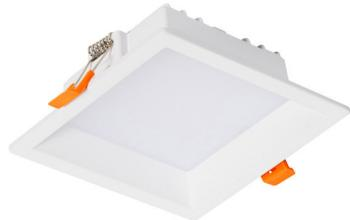
Luminária quadrada de embutir em forro de gesso, 14W 3000K IRC90. Corpo em alumínio injetado. Acabamento branco. Controle óptico principal através de difusor em poliestireno translúcido. Luminária grau de proteção IP-30. Driver corrente constante Liga/Desliga, Triac, 1-10V ou Dali (consultar condições). Tensão de trabalho 220V ou Bivolt.
