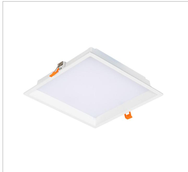
Luminária quadrada de embutir em forro de gesso, 23W 3000K IRC90. Corpo em alumínio injetado. Acabamento branco. Controle óptico principal através de difusor em poliestireno translúcido. Luminária grau de proteção IP-30. Driver corrente constante Liga/Desliga, Triac, 1-10V ou Dali (consultar condições). Tensão de trabalho 220V ou Bivolt.
