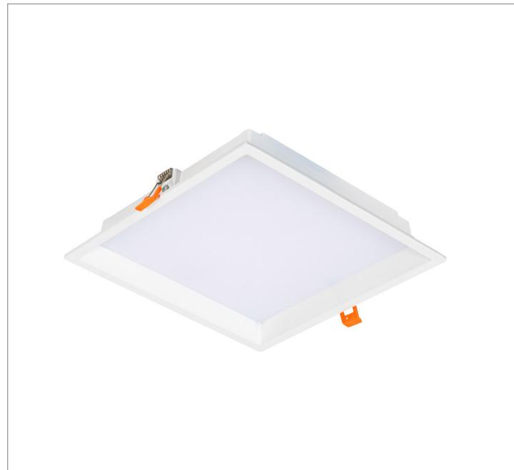
Luminária quadrada de embutir em forro de gesso, 27W 4000K IRC90. Corpo em alumínio injetado. Acabamento branco. Controle óptico principal através de difusor em poliestireno translúcido. Luminária grau de proteção IP-30. Driver corrente constante Liga/Desliga, Triac, 1-10V ou Dali (consultar condições). Tensão de trabalho 220V ou Bivolt.
