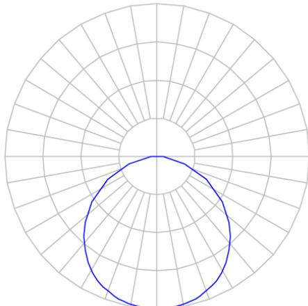
Luminária quadrada de embutir em forro de gesso, 35W 3000K IRC90. Corpo em alumínio injetado. Acabamento branco. Controle óptico principal através de difusor em poliestireno translúcido. Luminária grau de proteção IP-30. Driver corrente constante Liga/Desliga, Triac, 1-10V ou Dali (consultar condições). Tensão de trabalho 220V ou Bivolt.
