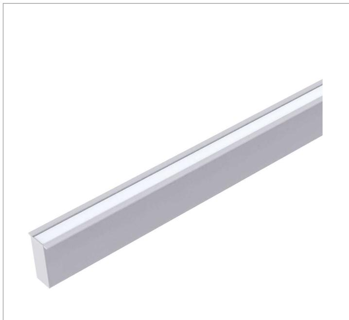
Luminária linear embutido de piso, 15Wm 4000K IRC>80. Corpo em alumínio. Acabamento Branca, Preta ou Especial. Controle óptico principal através de difusor extrudado. Luminária grau de proteção IP-65. Driver corrente constante Liga/Desliga, Triac, 1-10V ou Dali (consultar condições). Tensão de trabalho 220V ou Bivolt. Observação: É necessário o preparo de um dreno no local da instalação da luminária.
