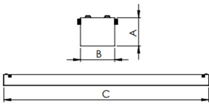
Luminária quadrada de sobrepor, 20W 5000K IRC>80. Corpo em alumínio. Acabamento Branca, Preta ou Especial. Controle óptico principal através de facho difuso. Luminária grau de proteção IP-20. Driver corrente constante Liga/Desliga, Triac, 1-10V ou Dali (consultar condições). Tensão de trabalho 220V ou Bivolt.
