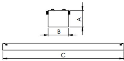
Luminária quadrada de sobrepor, 30W 2700K IRC>80. Corpo em alumínio. Acabamento Branca, Preta ou Especial. Controle óptico principal através de facho difuso. Luminária grau de proteção IP-20. Driver corrente constante Liga/Desliga, Triac, 1-10V ou Dali (consultar condições). Tensão de trabalho 220V ou Bivolt.
