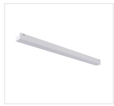
Luminária retangular de sobrepor, 10W 3000K IRC>80. Corpo em alumínio. Acabamento Branca, Preta ou Especial. Controle óptico principal através de facho difuso. Luminária grau de proteção IP-20. Driver corrente constante Liga/Desliga, Triac, 1-10V ou Dali (consultar condições). Tensão de trabalho 220V ou Bivolt.
