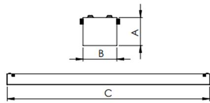
Luminária retangular de sobrepor, 10W 5000K IRC>80. Corpo em alumínio. Acabamento Branca, Preta ou Especial. Controle óptico principal através de facho difuso. Luminária grau de proteção IP-20. Driver corrente constante Liga/Desliga, Triac, 1-10V ou Dali (consultar condições). Tensão de trabalho 220V ou Bivolt.
