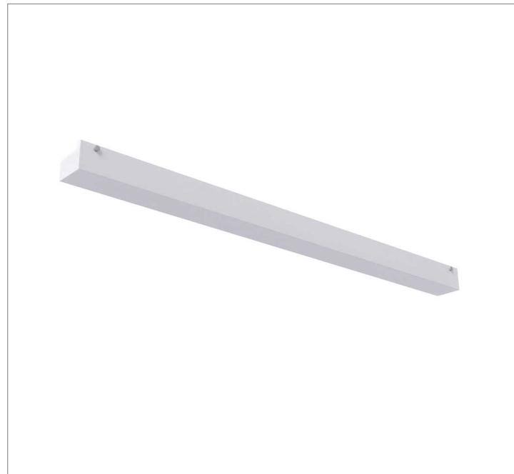
Luminária retangular de sobrepor, 20W 2700K IRC>80. Corpo em alumínio. Acabamento Branca, Preta ou Especial. Controle óptico principal através de facho difuso. Luminária grau de proteção IP-20. Driver corrente constante Liga/Desliga, Triac, 1-10V ou Dali (consultar condições). Tensão de trabalho 220V ou Bivolt.
