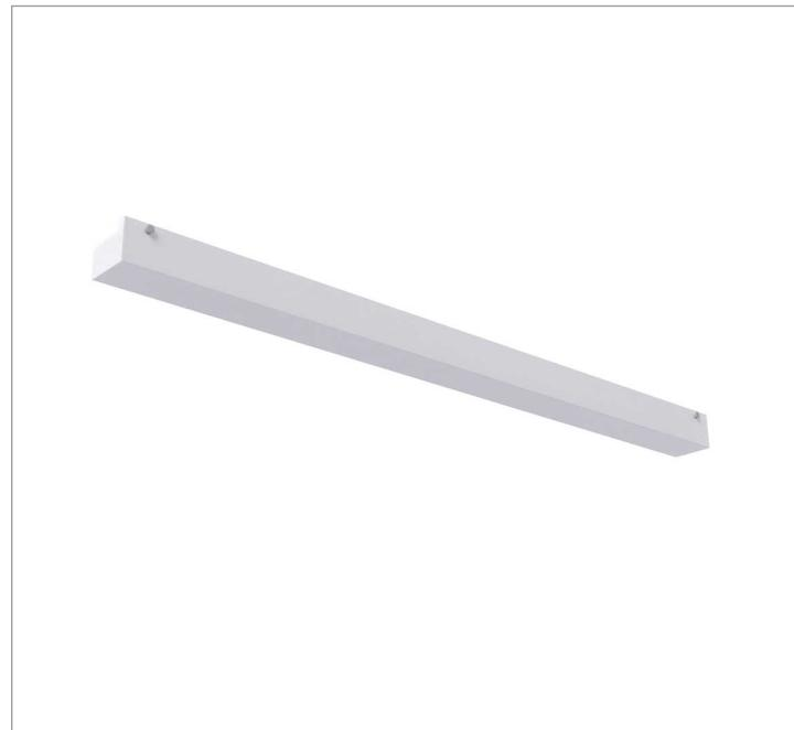
Luminária retangular de sobrepor, 20W 5000K IRC>80. Corpo em alumínio. Acabamento Branca, Preta ou Especial. Controle óptico principal através de facho difuso. Luminária grau de proteção IP-20. Driver corrente constante Liga/Desliga, Triac, 1-10V ou Dali (consultar condições). Tensão de trabalho 220V ou Bivolt.
